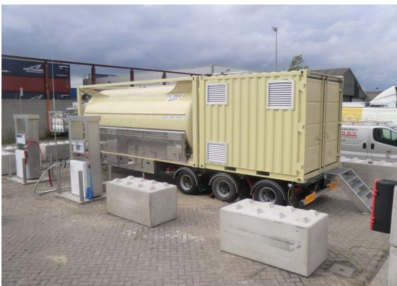
Figuur 1 - Voorbeeld van een mobiel LNG vulstation (zoals werd gebruikt door Rolande LNG in Tilburg)
