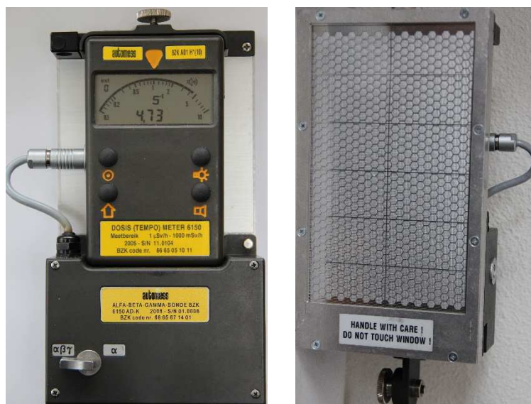
Figuur 7.8 Automess met AD-k; links de meter in de \alpha\beta\gamma -sonde met aangesloten kabel en rechts de onderzijde van de sonde zonder kap, het meetoppervlak.
