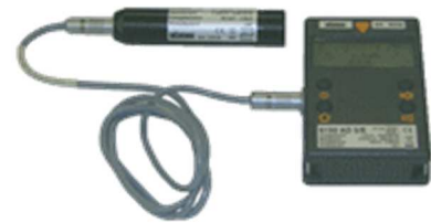
Figuur 7.3 Sonde via sondekabel aangekoppeld
