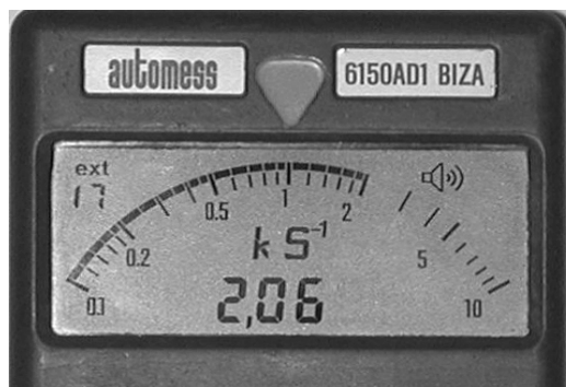
Figuur 7.7 Display met sonde AD-17 meet 2,06 ks^{-1} = ong. 2000 cps; in de linkerbovenhoek van het display staat de gebruikte sonde
