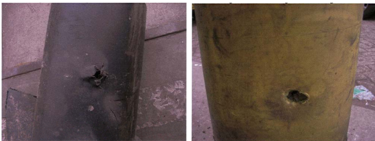
Figuur 1.2 De twee beschadigde buisleidingen (incident Amsterdam)
