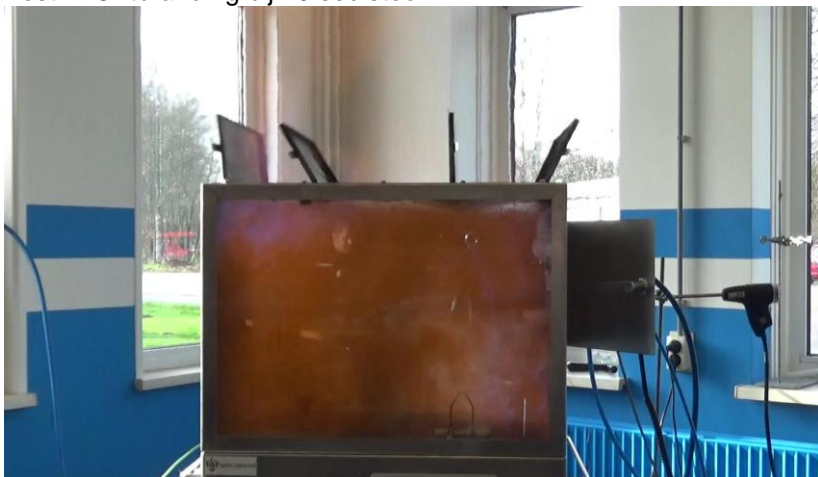
Test 4: Ontbranding bij 20 sec stoom
