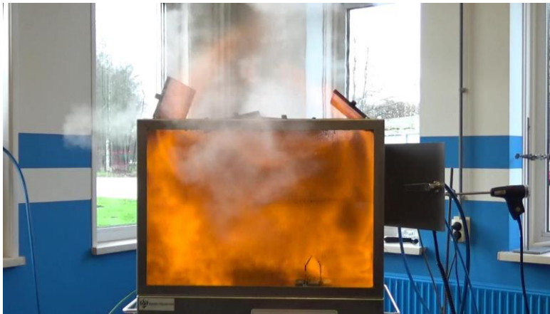
Test 12: Ontbranding bij 300 sec stoom
