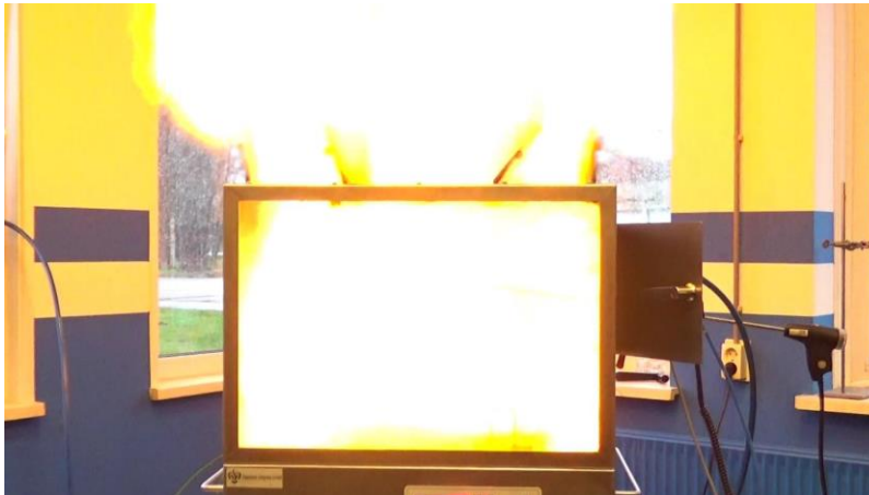
Test 2: Ontbranding bij 10 sec nevel
