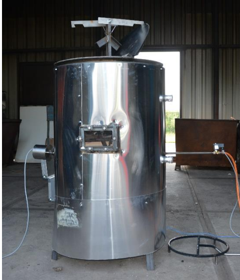
Afbeelding 2: Plofvat met rechtsonder de brander
