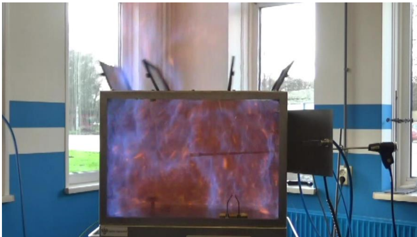
Test 6: Ontbranding bij 30 sec stikstof
