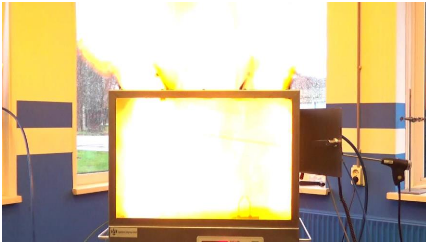
Test 4: Ontbranding bij 20 sec nevel
