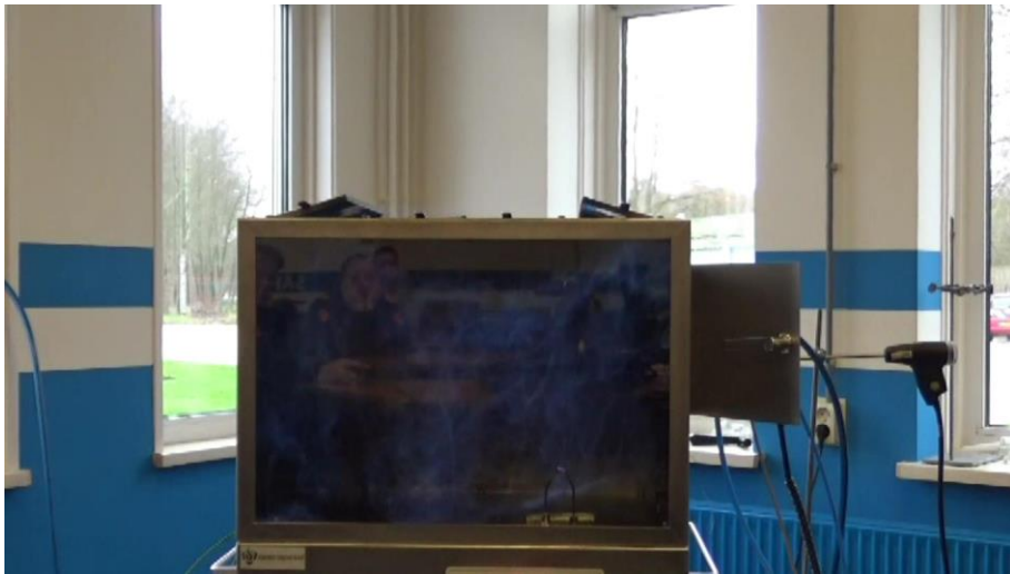
Test 12: Ontbranding bij 180 sec stikstof
