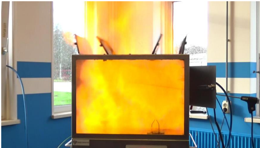
Test 10: Ontbranding bij 120 sec nevel
