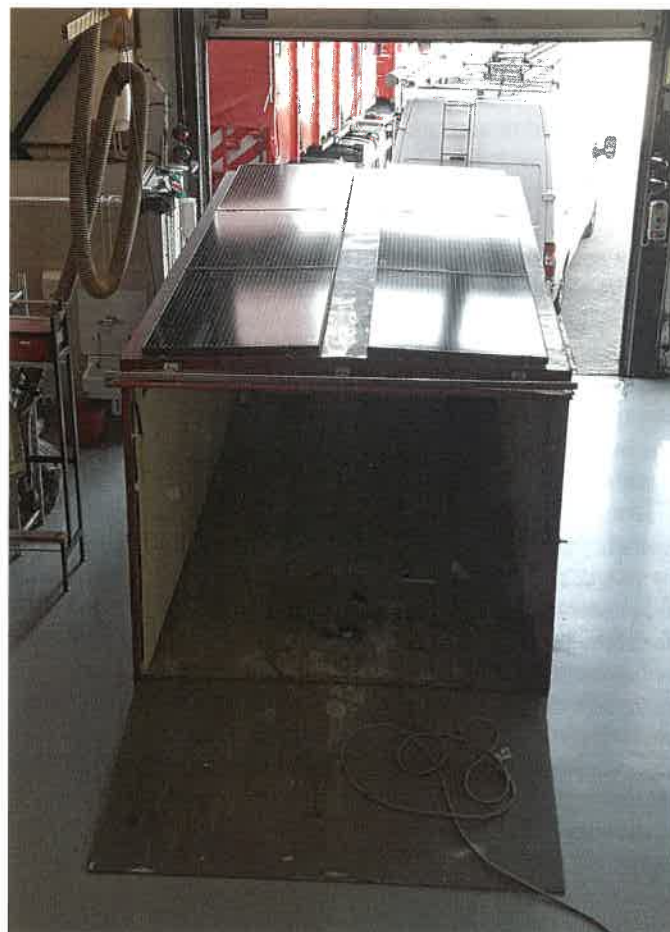
Peter Eijgenraam heeft samen met zijn collega's een container omgebouwd tot oefenobject. Met de erop geïnstalleerde zonnepanelen kunnen brandweerlieden uit de regio oefenen.
