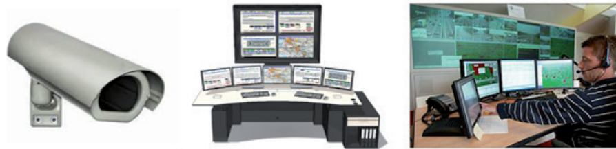
Figuur C.7 / Illustratie CCTV-systeem en centrale bediening.
