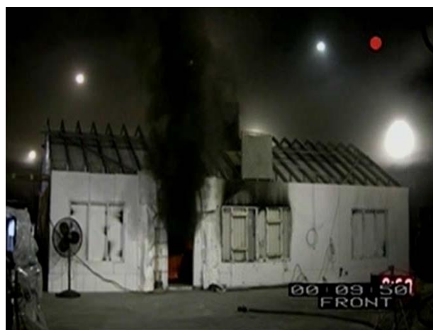
Figuur 4.5: 5 seconden na dakventilatie
