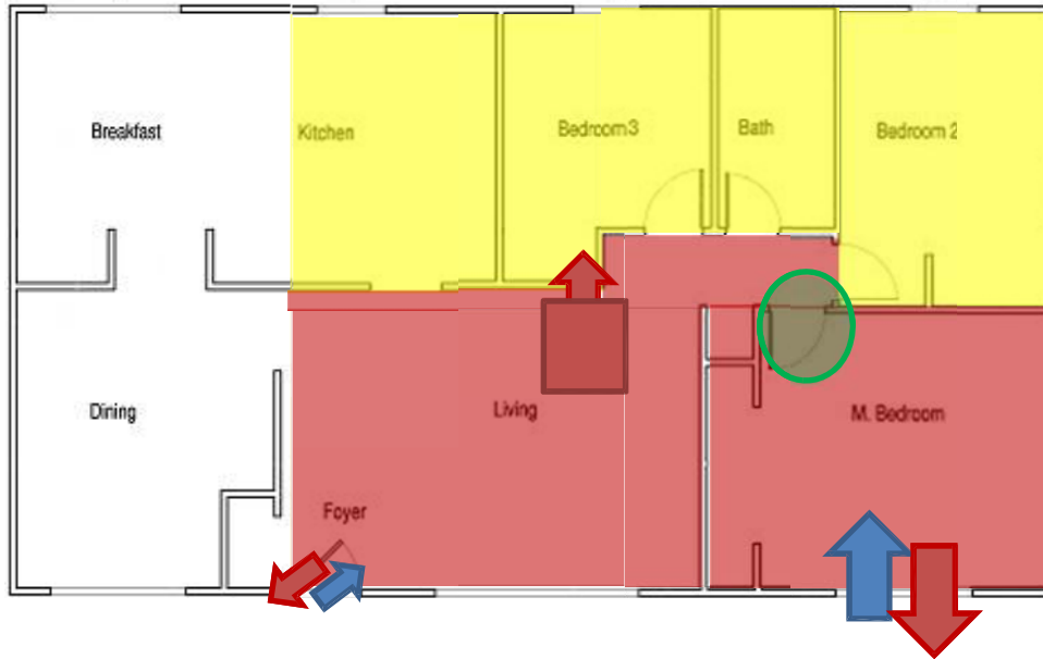
Figuur 4.18: Stromingspaden nadat het raam van de slaapkamer aan de voorzijde is geopend
