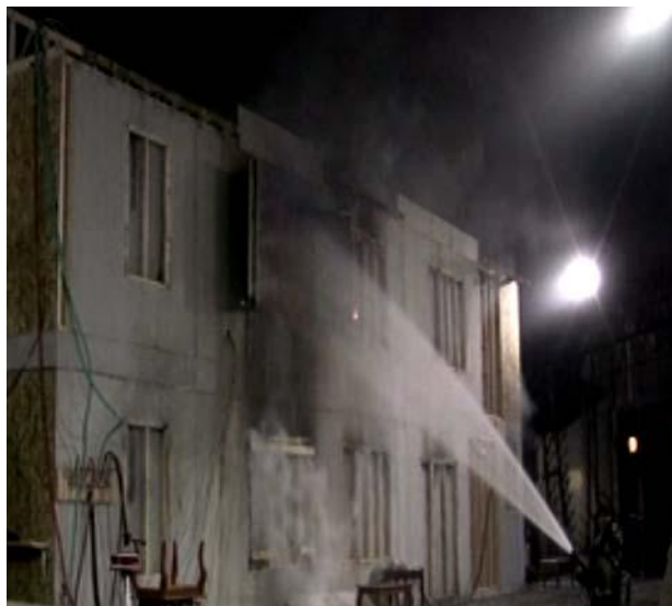
Figuur 4.36: Nevelstraal sluit stromingspad af
