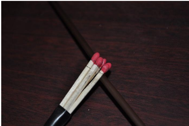
Figuur 3.13: Ontstekingsmechanisme met lucifers
