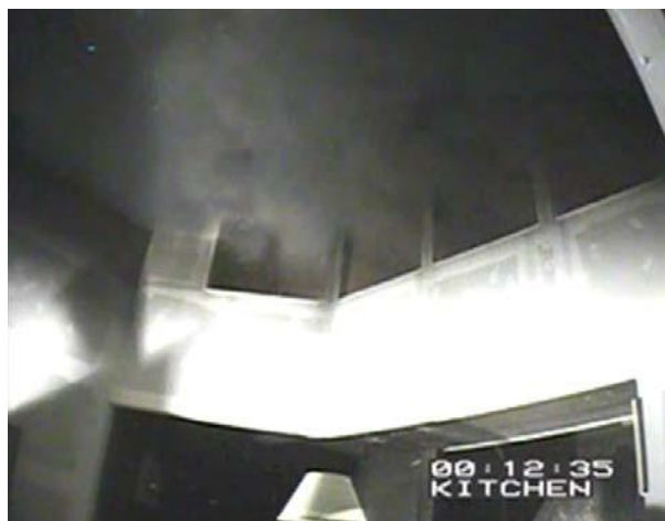
Figuur 4.31: Na vijf seconden water aanbrengen, zichtbaar gedoofde vlammen
