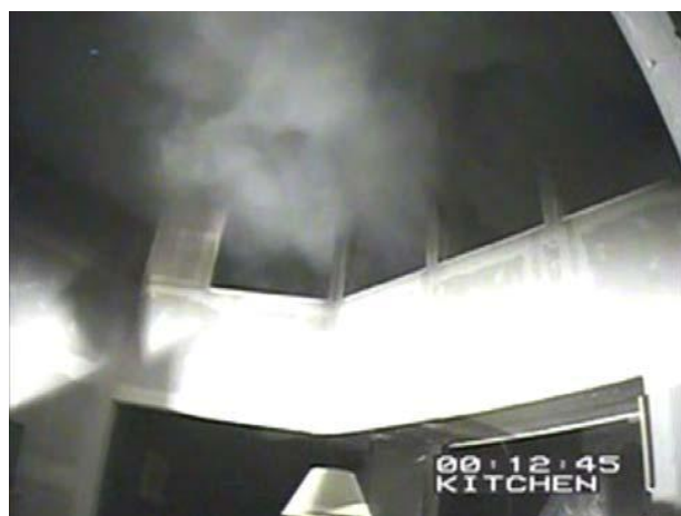
Figuur 4.32: Bij het einde van water aanbrengen, stoom verplaatst zich naar de ventilatieopening in het dak
