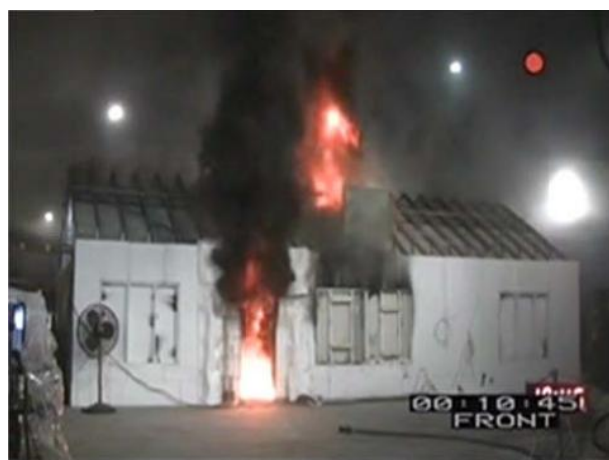
Figuur 4.6: 60 seconden na dakventilatie
