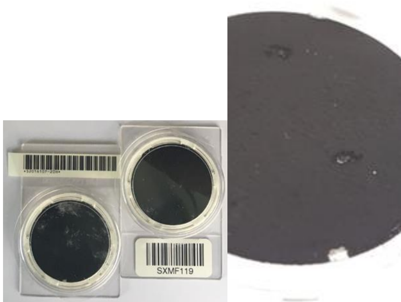
Afbeelding 3: twee gebruikte filters en rechts een detail van een van de filters waarbij de roetlaag dikte zichtbaar is.
