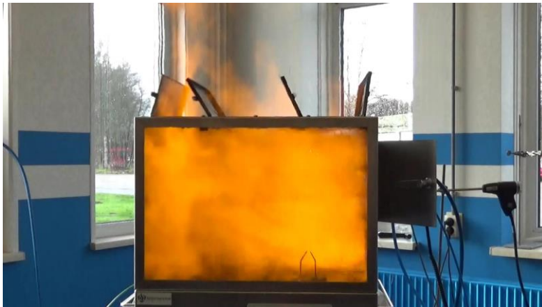
Test 5: Ontbranding bij 30 sec stoom
