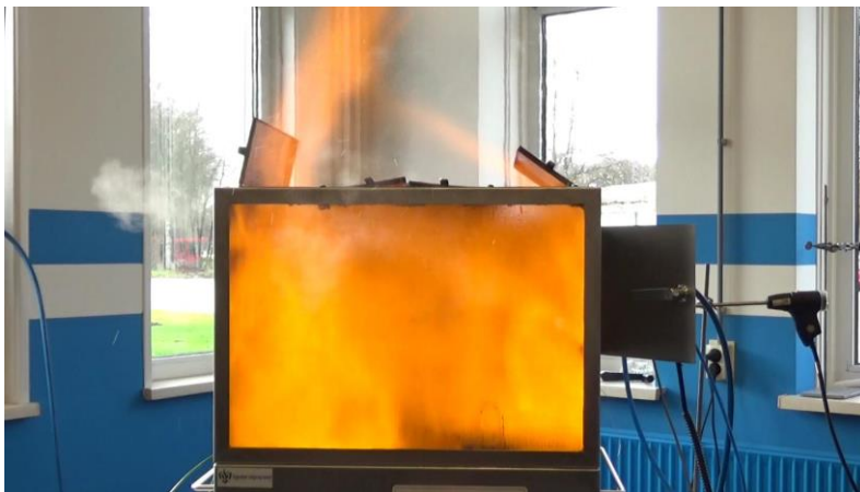
Test 12: Ontbranding bij 300 sec stoom
