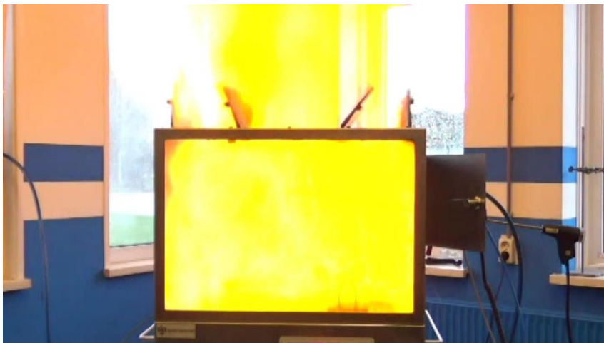
Test 6: Ontbranding bij 30 sec nevel
