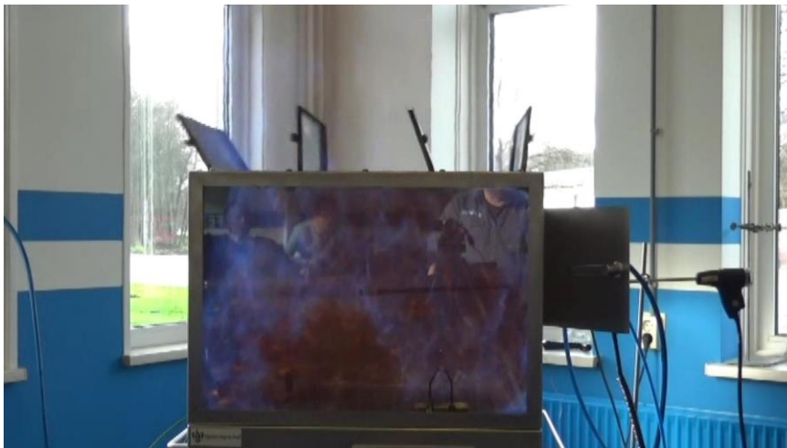
Test 8: Ontbranding bij 60 sec stikstof
