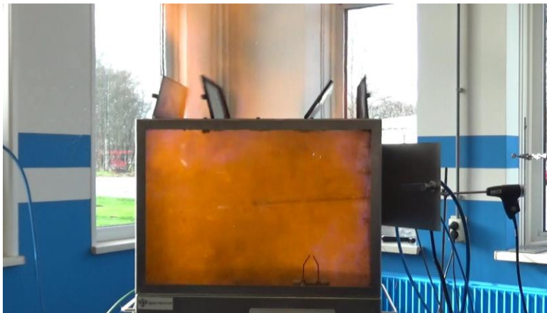
Test 2: Ontbranding bij 10 sec stoom
