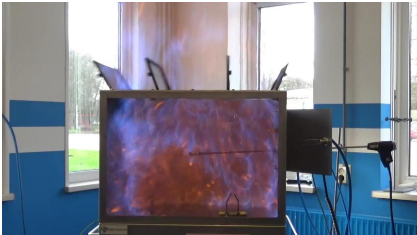
Test 6: Ontbranding bij 30 sec stikstof
