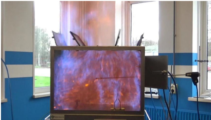
Test 4: Ontbranding bij 20 sec stikstof
