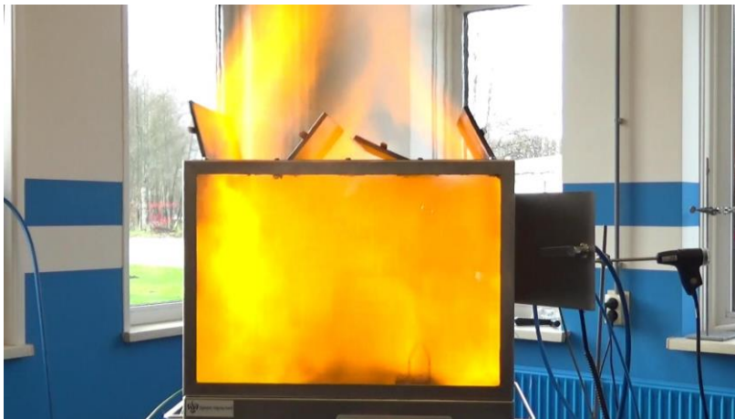
Test 10: Ontbranding bij 120 sec stoom
