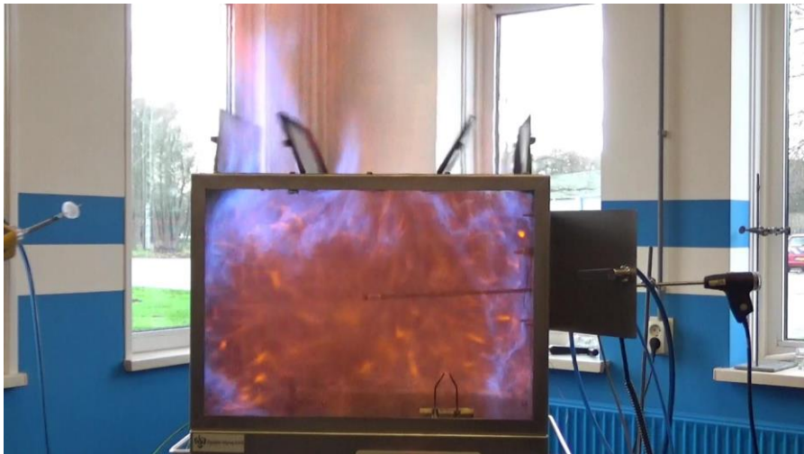
Test 2: Ontbranding bij 10 sec stikstof
