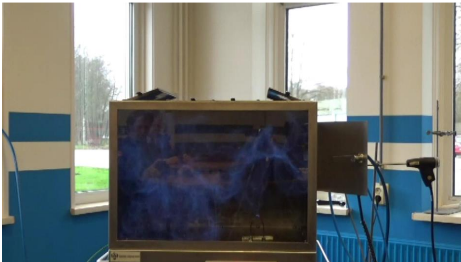
Test 12: Ontbranding bij 180 sec stikstof
