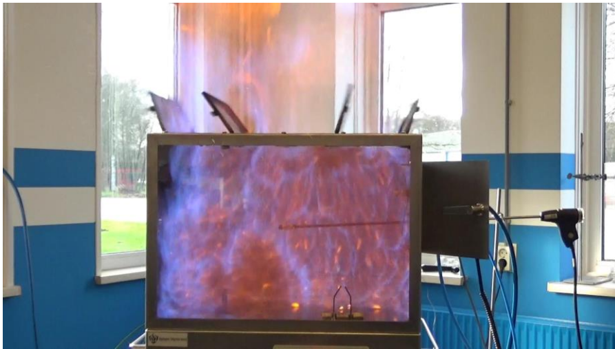
Test 2: Ontbranding bij 10 sec stikstof
