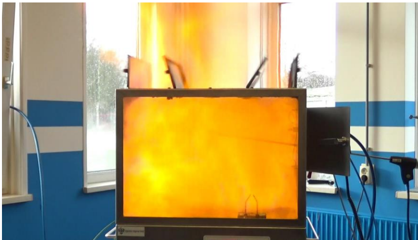
Test 10: Ontbranding bij 120 sec nevel
