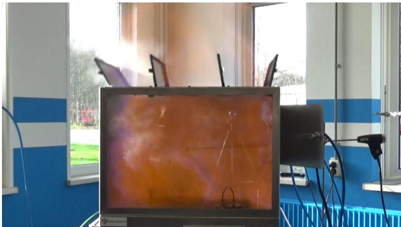
Test 4: Ontbranding bij 20 sec stoom
