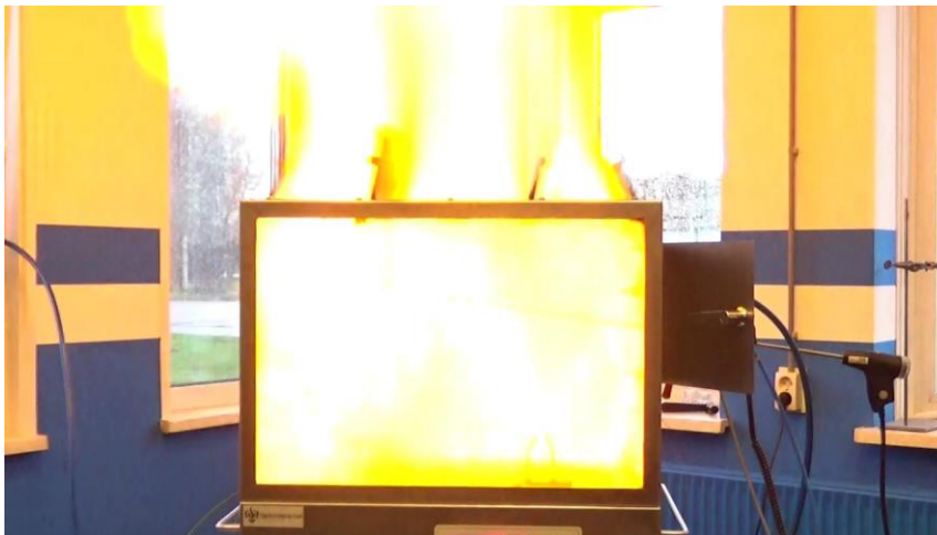
Test 4: Ontbranding bij 20 sec nevel
