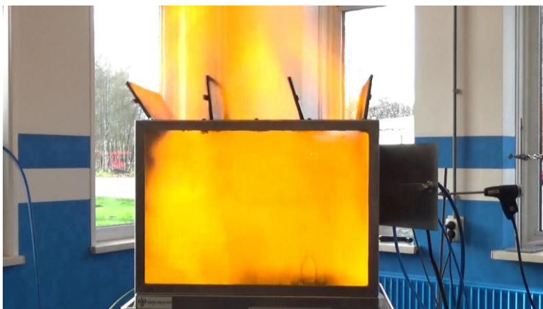
Test 8: Ontbranding bij 60 seconden stoom
