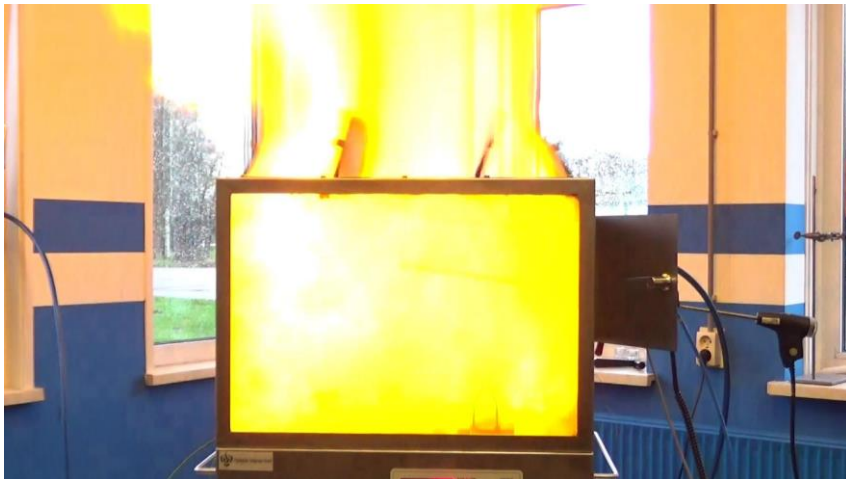
Test 6: Ontbranding bij 30 sec nevel
