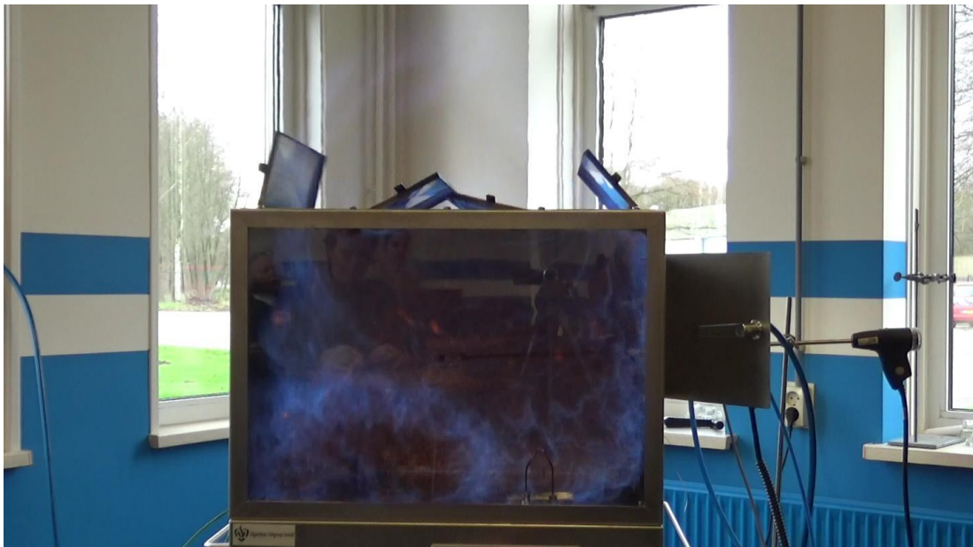
Test 10: Ontbranding bij 120 sec stikstof
