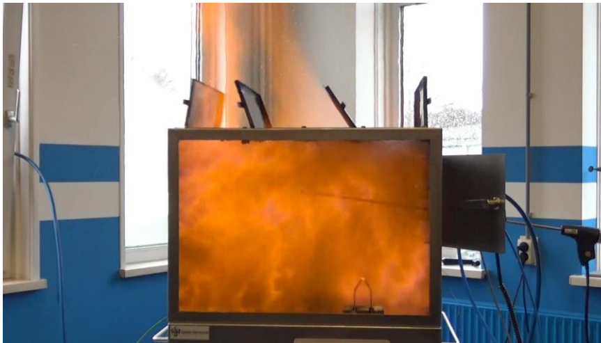
Test 12: Ontbranding bij 300 sec nevel
