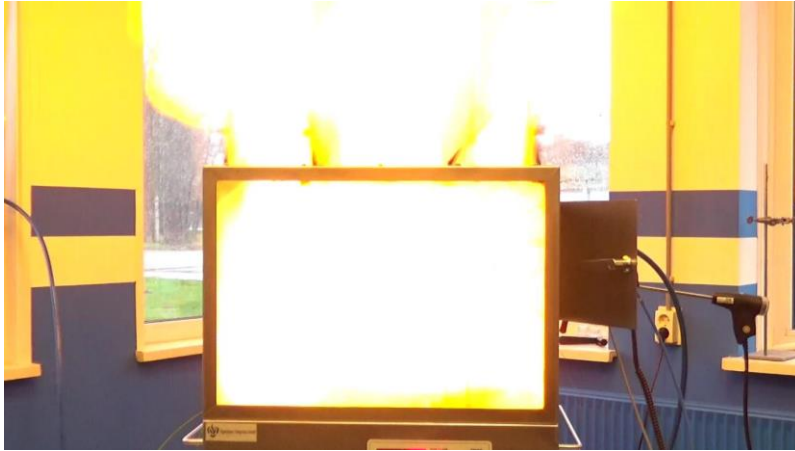
Test 2: Ontbranding bij 10 sec nevel
