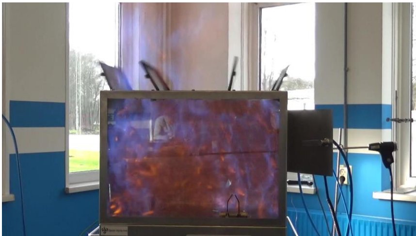
Test 4: Ontbranding bij 20 sec stikstof
