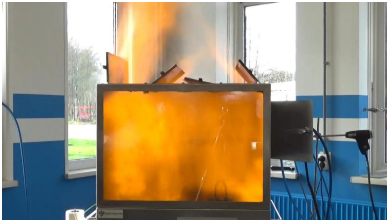
Test 9: Ontbranding bij 120 sec stoom
