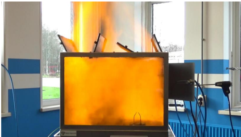
Test 8: Ontbranding bij 60 seconden stoom
