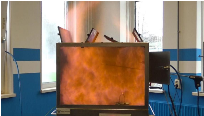
Test 12: Ontbranding bij 300 sec nevel
