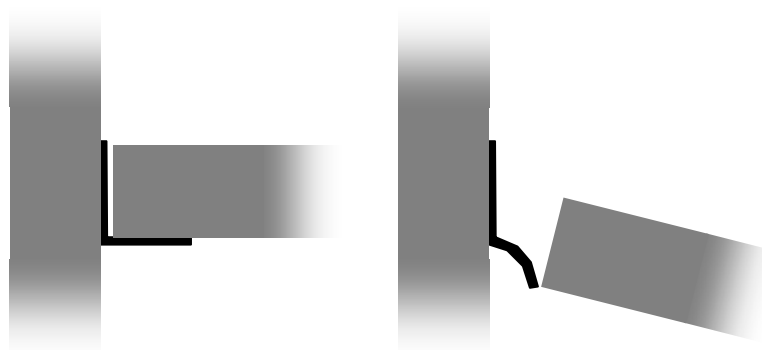
Figuur 27: bezwijken vloer door uitbuigen onderflens hoekstaal (hier niet opgetreden).
