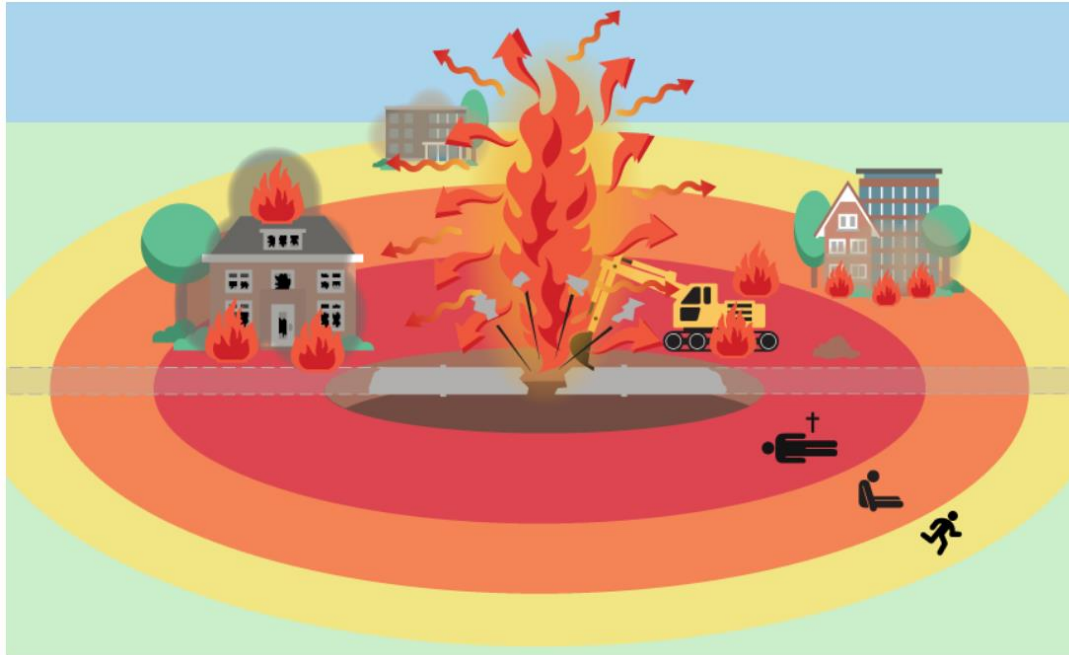
Figuur 2.2 Voorbeeld fakkelbrand bij hogedrukbuisleiding: hogedrukaardgasleiding
