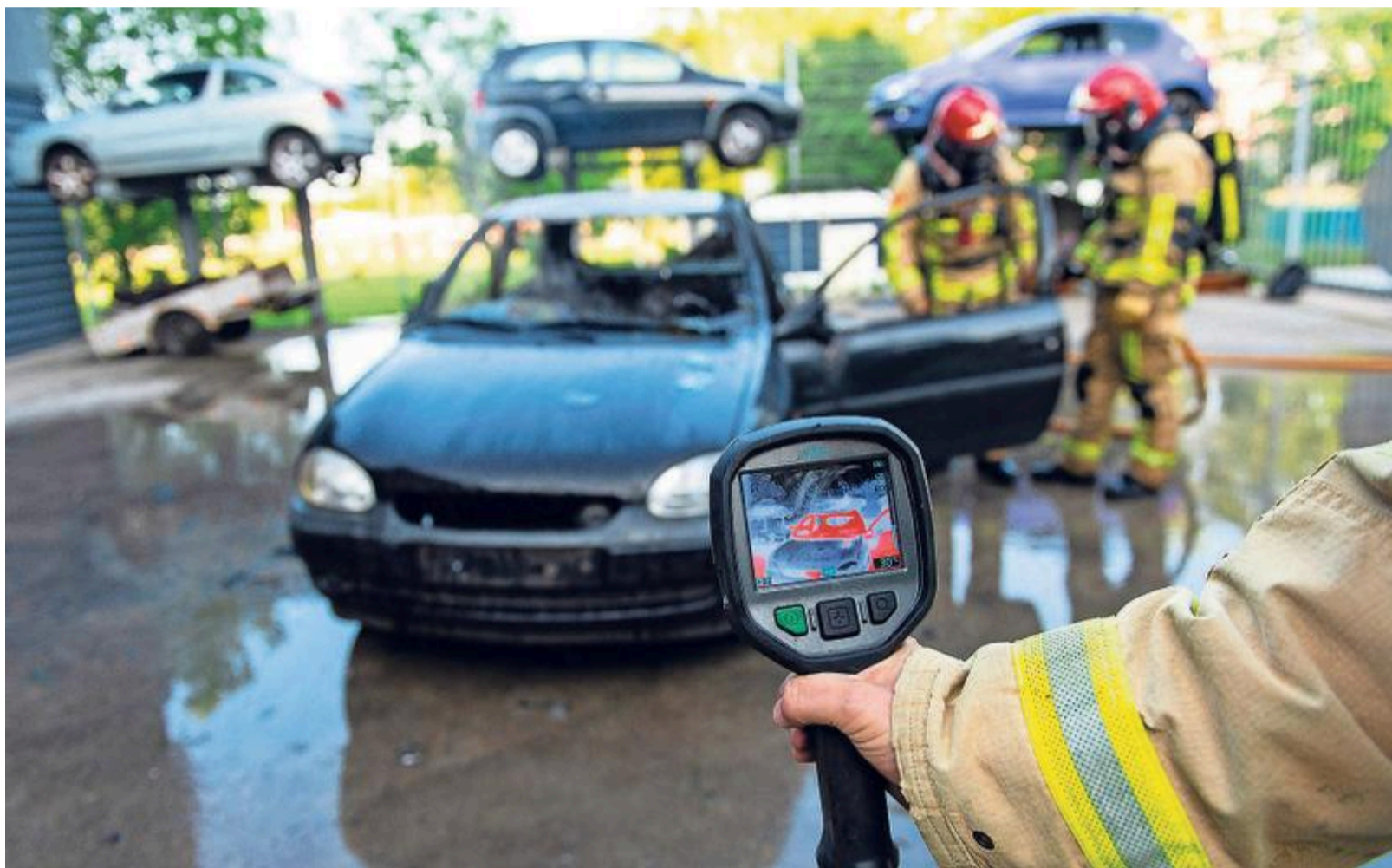
Een warmtebeeldcamera is noodzakelijk om bij brandende elektrische auto's de temperatuur in de gaten te houden.
