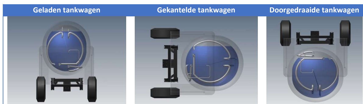
Figuur 1 - Gas & vloeistoffase ivf positie van de tankwagen
