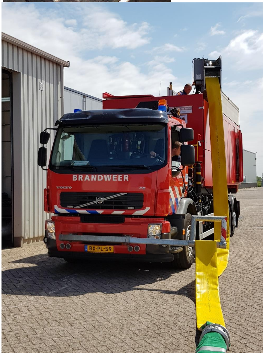
Afb. boven: HRU en bumperrol in bedrijf op HA-voertuig
