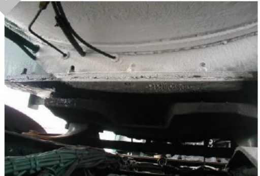
Afbeelding 30: Isolatie materiaal tussen binnen- en buitentank
