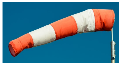
Afbeelding 11: Windzak voor het vaststellen van de windrichting bij een LNG tankstation
