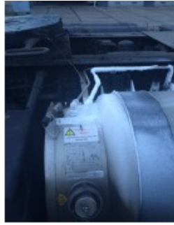
Afbeelding 5: IJsvorming na lekkage LNG brandstoftank (bron: Brandweeroptreden bij incidenten met LNG (IFV))
