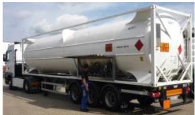
Afbeelding 22: LNG-tankcontainer op trailer met bedieningskast aan de zijkant
