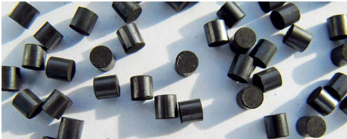
Figuur 2.7: Voorbeeld G22-2 katalysatorpellets.
