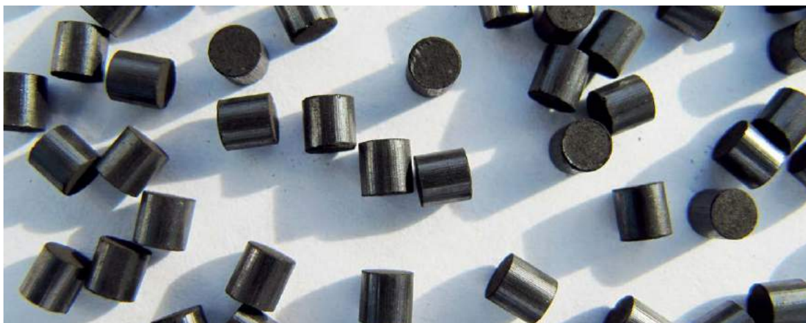
Figuur B5.2: Voorbeeld G22-2 katalysatorpellets.
