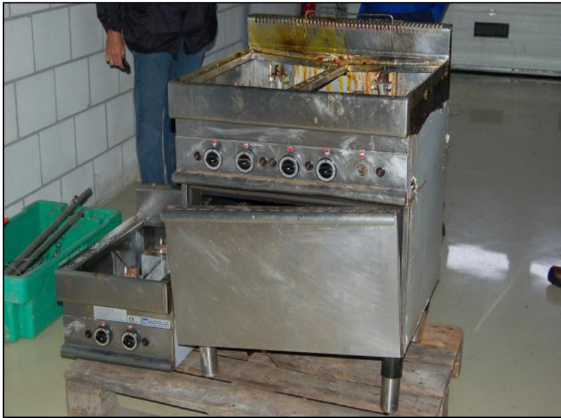
Afbeelding 12: Fornuis klaar voor transport voor nader onderzoek, aanwezige bedieningsknoppen in nulstand gedraaid (de ovenknop is de 3 e van links, rechts mist de knop van een gaspit) (foto: TNO Bouw en Dienstverlening)
