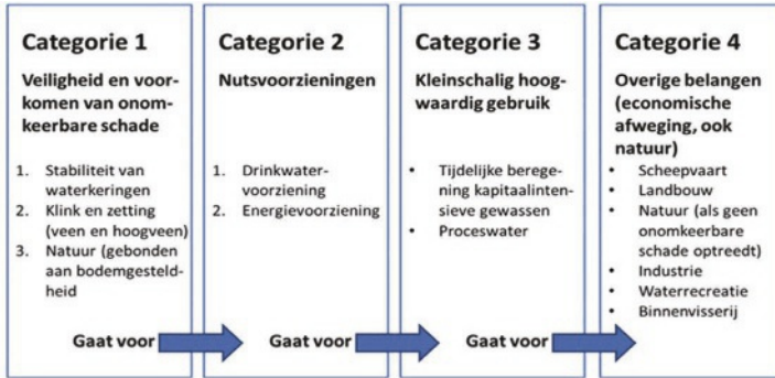
Figuur 10.2 Verdringsreeks voor de waterverdeling ten tijde van watertekort of droogte
