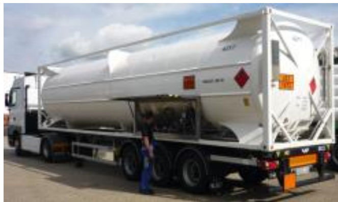
Afbeelding 5.8 Tankcontainer op trailer met bedieningskast aan de zijkant
