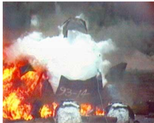
Afbeelding 1.9 Opwarmen drukhouder met tot vloeistof verdicht gas (links), gevolgd door bezwijken drukhouder (rechts)
