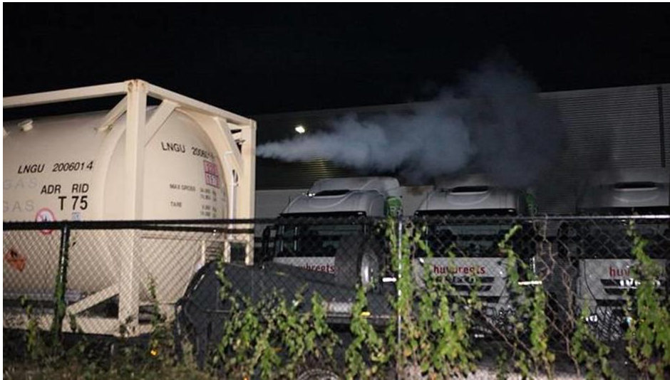
Afbeelding 8.3 Afblaasventiel in werking (vorming BOG) = normaal proces
