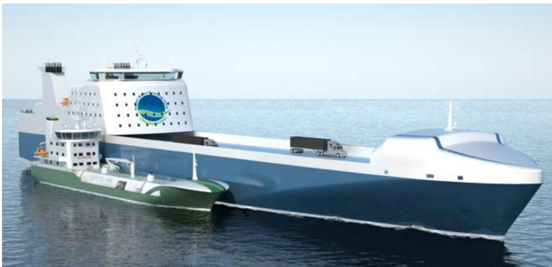
Afbeelding 6.7 Schip dat LNG gebruikt als brandstof wordt getankt vanuit een LNG-bunkerschip
