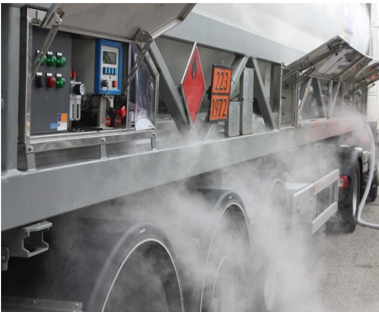
Afbeelding 7.2 Lossen van LNG met condensvorming
