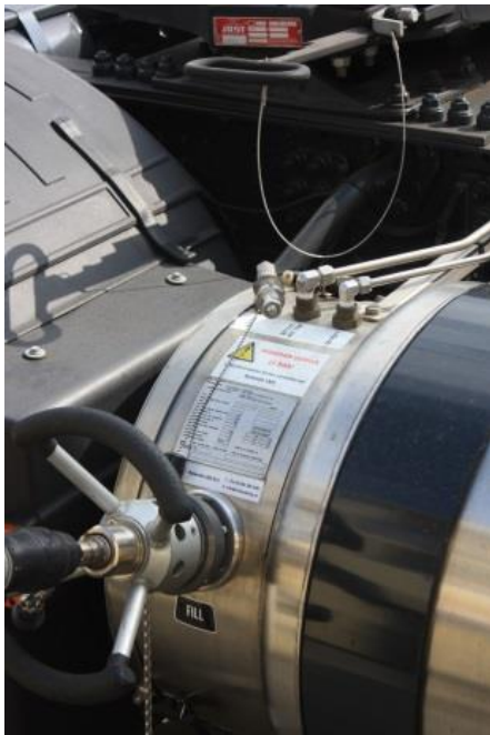
Afbeelding 7.6 Aansluiting aflever slang op tank
