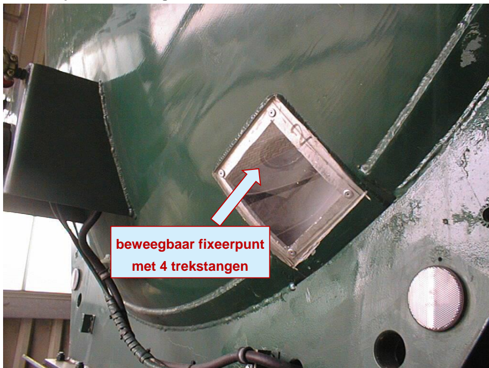
Afbeelding 5.13 In deze tankwagen is voor oefendoeleinden het fixeerpunt zichtbaar gemaakt
