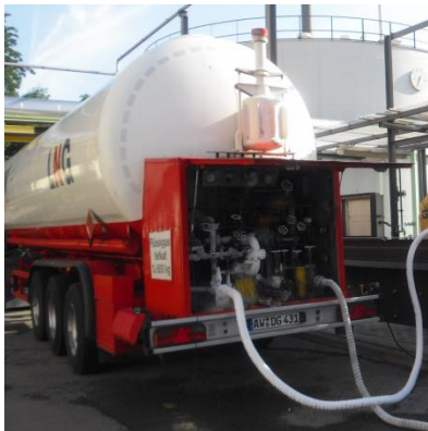
Afbeelding 5.7 LNG-tankwagen met bedieningskast achterop
