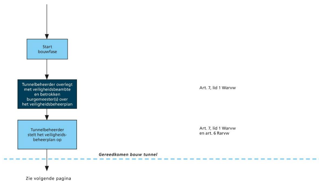
Figuur 2.4A Stroomschema van de bouwfase tot het gereedkomen van de bouw. De donkerblauwe kleur geeft aan bij welke stap(pen) een gemeentelijke bestuurlijke activiteit aan de orde is.
