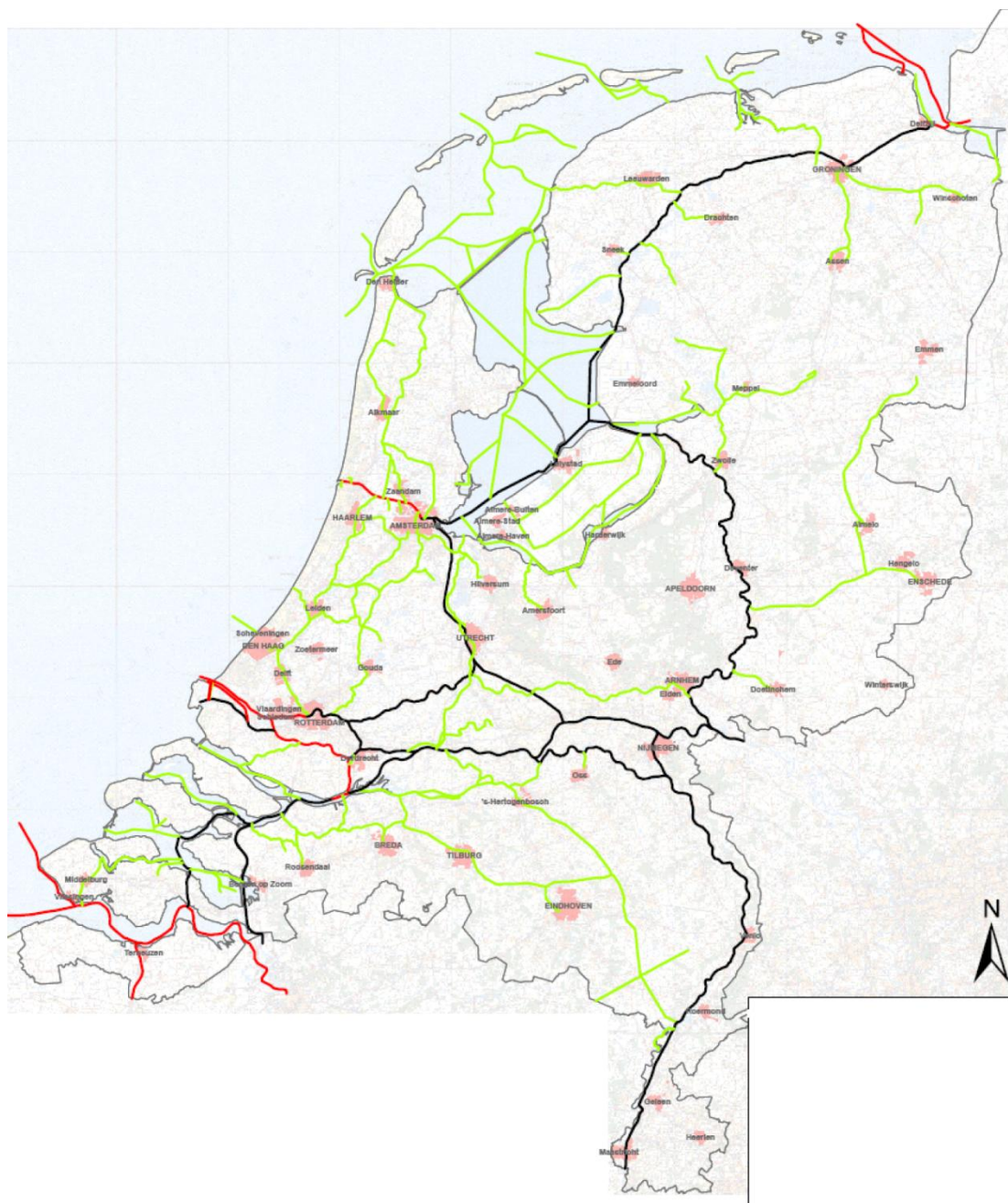
Afbeelding 4: kaart Basisnet water (Bron: Definitief ontwerp Basisnet Water. Ten behoeve van besluitvorming binnen het project Basisnet (Werkgroep Basisnet Water, 15 januari 2008)) Legenda: Rode routes: Belangrijke toegangen naar zeehavens, geen plafond voor het plaatsgebonden risico en het groepsrisico. Naar verwachting komt de plaatsgebonden risicocontour van 10^{-6} niet verder dan de oever. Indien de PR 10^{-6} -contour de oever wel raakt, grijpt het Rijk in. Zwarte routes: Belangrijke vaarwegen, verder hetzelfde als de rode routes. Groene routes: Minder belangrijke vaarwegen. PR 10^{-6} komt naar verwachting helemaal niet voor. 8
