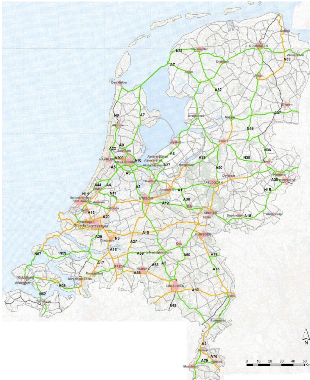
Afbeelding 2: kaart 'Veiligheidszones' Basisnet weg (Bron: Eindrapportage Basisnet weg, Arcadis/Basisnet werkgroep weg, versie 1.0, oktober 2009). Legenda: groen = geen veiligheidszone; oranje = wel veiligheidszone 7
